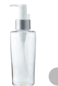
フィオーレPET 150AT FIORE PET 150AT 150mL PET (ダイレクトブロー) PET (Direct Blow) H119.6×Φ50.9 (mm) CAP: Z-700kp AT-P1
