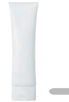
TML40多層OVチューブ TML40 MULTILAYER OVAL TUBE 60~130g PE/EVOH/PE (エクストリュージョン) PE/EVOH/PE (Extrusion) H90.0~170.0×W45.46×D22.8(mm) CAP: TML40ヒンジ
