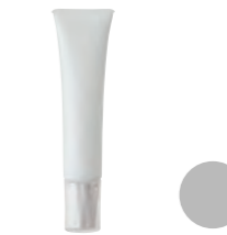
φ22多層チューブ φ22 MULTILAYER TUBE 13~35g PE/EVOH/PE (エクストリュージョン) PE/EVOH/PE (Extrusion) H60.0~120.0×Φ22.0 (mm) CAP: BJチューブキャップ MT-2
