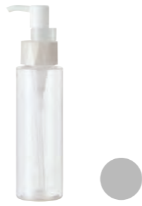
レイPET 100AT REY PET 100AT 100mL PET (インジェクションストレッチブロー) PET (Injection Stretch Blow) H123.2×Φ39.0 (mm) CAP: Z-700BJ AT-P1
