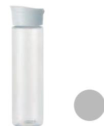
SB05-120C SB05-120C 120mL PET (インジェクションストレッチブロー) PET (Injection Stretch Blow) H135.1×Φ39.0 (mm) CAP: SU-28ヒンジキャップ
