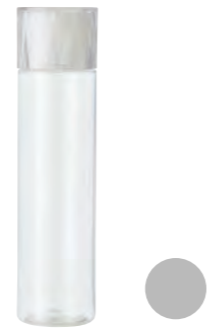
レイPET 180AT REY PET 180AT 180mL PET (インジェクションストレッチブロー) PET (Injection Stretch Blow) H158.1×Φ44.6 (mm) CAP: BJ-180LWc L-P7
